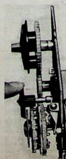
Bild 10. Links: Seitenansicht des VHF-Tuners mit mechanischer Speicherautomatik. Rechts: Blick von oben auf den VHF-Tuner. Oberer Knopf Kanalschaltung; unterer Knopf einmalige Feinabstimmung; darunter Scheibe mit Einstellschrauben (für jeden Kanal eine), die auf eine Wippe drücken. Mit der Wippe fest verbunden ist der Einstellferriker, dessen Eintauchtiefe in die Spule L1 von der Wippenstellung abhängt
