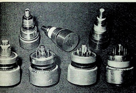
Bild 1. Koaxialröhren; obere Reihe von links nach rechts: 2C39A, 2x3CX100A5; untere Reihe von links nach rechts: 4X150G, 4X150A, 4X150D, 4X250B
